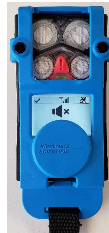
Ventis Pro met Standby Clip (man-down en gasuitlezingen op stand-by)
