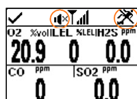
De peer- en man-down-functies staan op stand-by (omcirkelde symbolen) en zijn niet operationeel. De Standby Clip is bevestigd.
