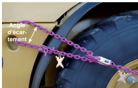
Image 13: Raccordement de la chaîne sans fin ICE
