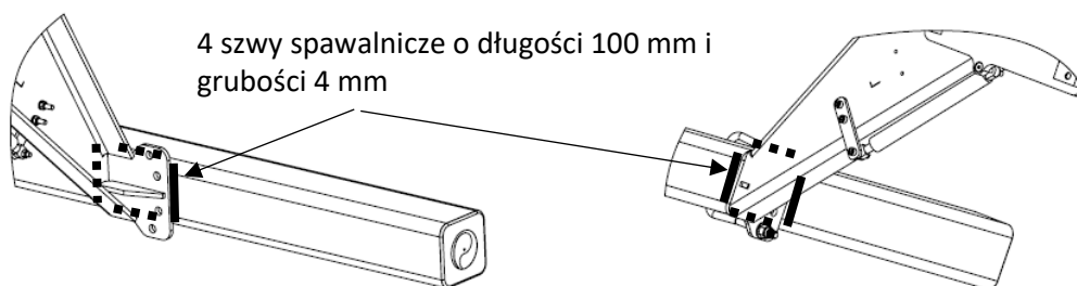
Mocowanie przez spawanie, Rysunek 27
