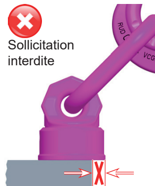
Fig. 3 : Le VWBG doit totalement adhérer à la surface (appui \geq D )
